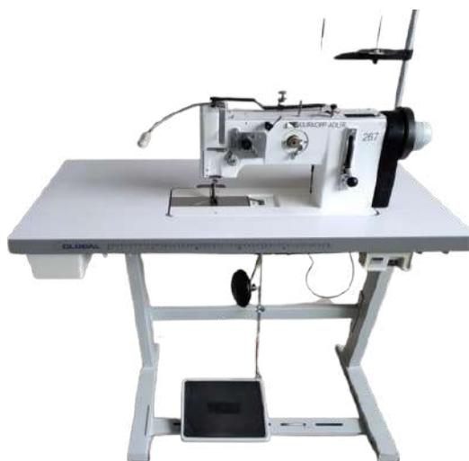
La Machine à coudre Durkopp est un équipement universel permettant la **couture de matériaux d'épaisseur moyenne** tels que le cuir ou les textiles.
